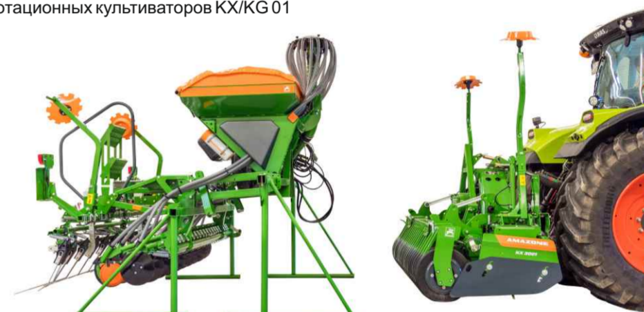
Благодаря модульной системе можно комбинировать друг с другом различные почвообрабатывающие орудия и сеялки AMAZONE.
